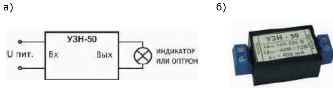
Рис. 4 Схема подключения (а) и внешний вид (б) устройства защиты от наводок 3
